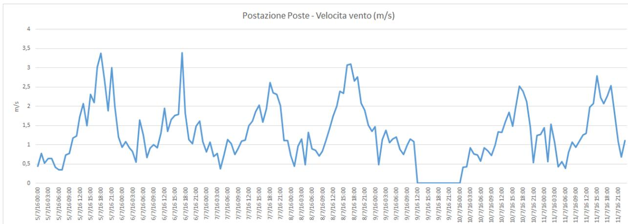
**Figura 21:** Velocità del vento nella settimana, centralina Poste
