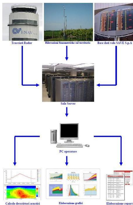
Figura 2: Schema di funzionamento del software SARA
