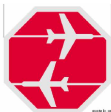
Figura 10 Segnaletica orizzontale di pericolo “passaggio di aeromobili”
