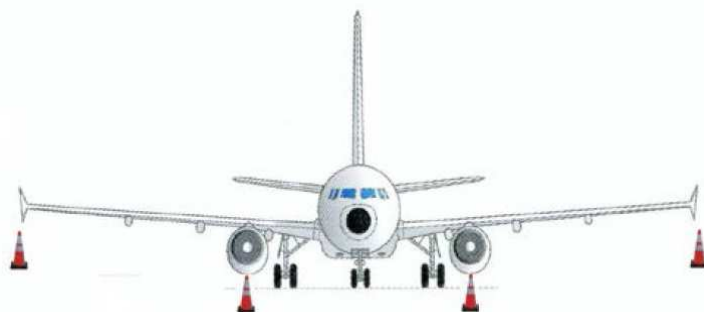
Figura 30 Posizionamento coni segnaletici
