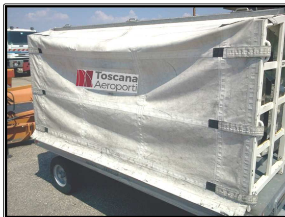
Figura 33 Corretta chiusura del telo
