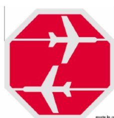
Figura 11 Segnaletica orizzontale di pericolo "passaggio di aeromobili"
