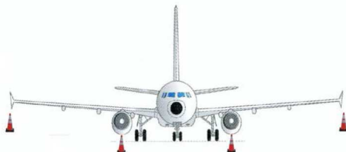
Figura 30 Posizionamento coni segnaletici
