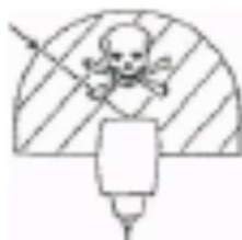
Figura 23 La distanza dai motori deve essere oltre 10 metri.
