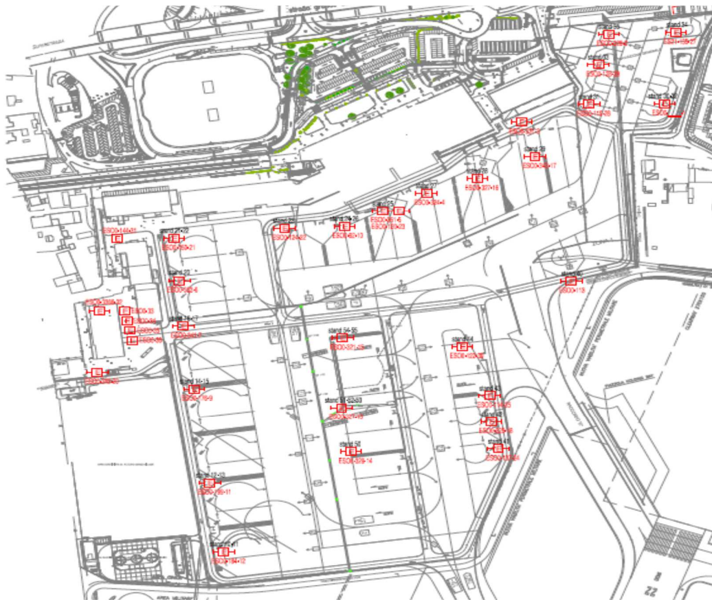
Figura 25 Mappa della distribuzione Estintori sul Piazzale
