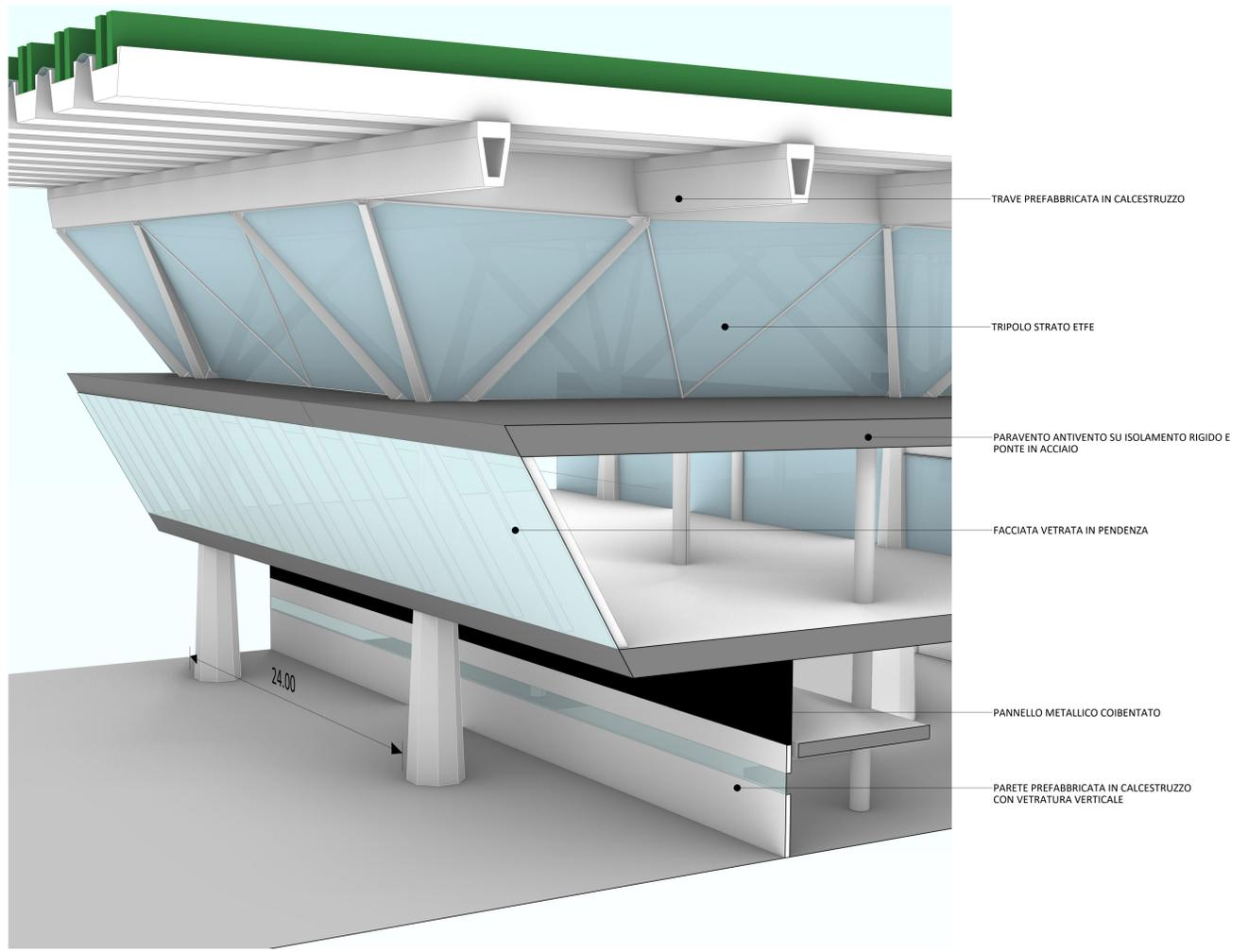
INTERFACCIA TIPO STRUTTURA-INVOLUCRO non in scala **3**
