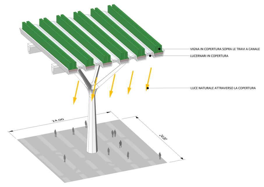
MODULO STRUTTURALE TIPO 24x24m non in scala **1**
