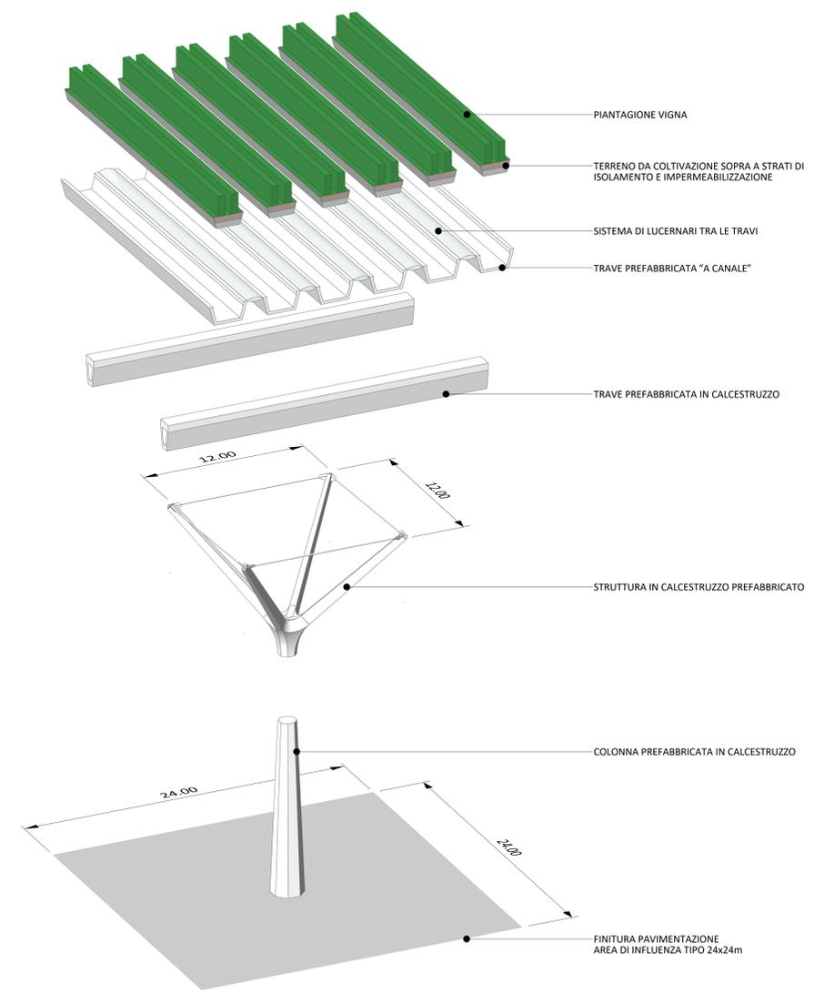
MODULO STRUTTURALE TIPO 24x24m - ESPLOSO non in scala **2**
