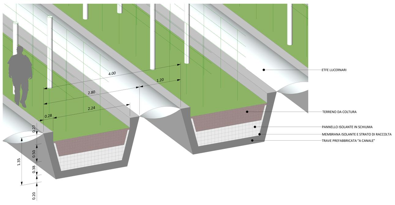
SCHEMA DI ASSEMBLAGGIO COPERTURA non in scala **4**
