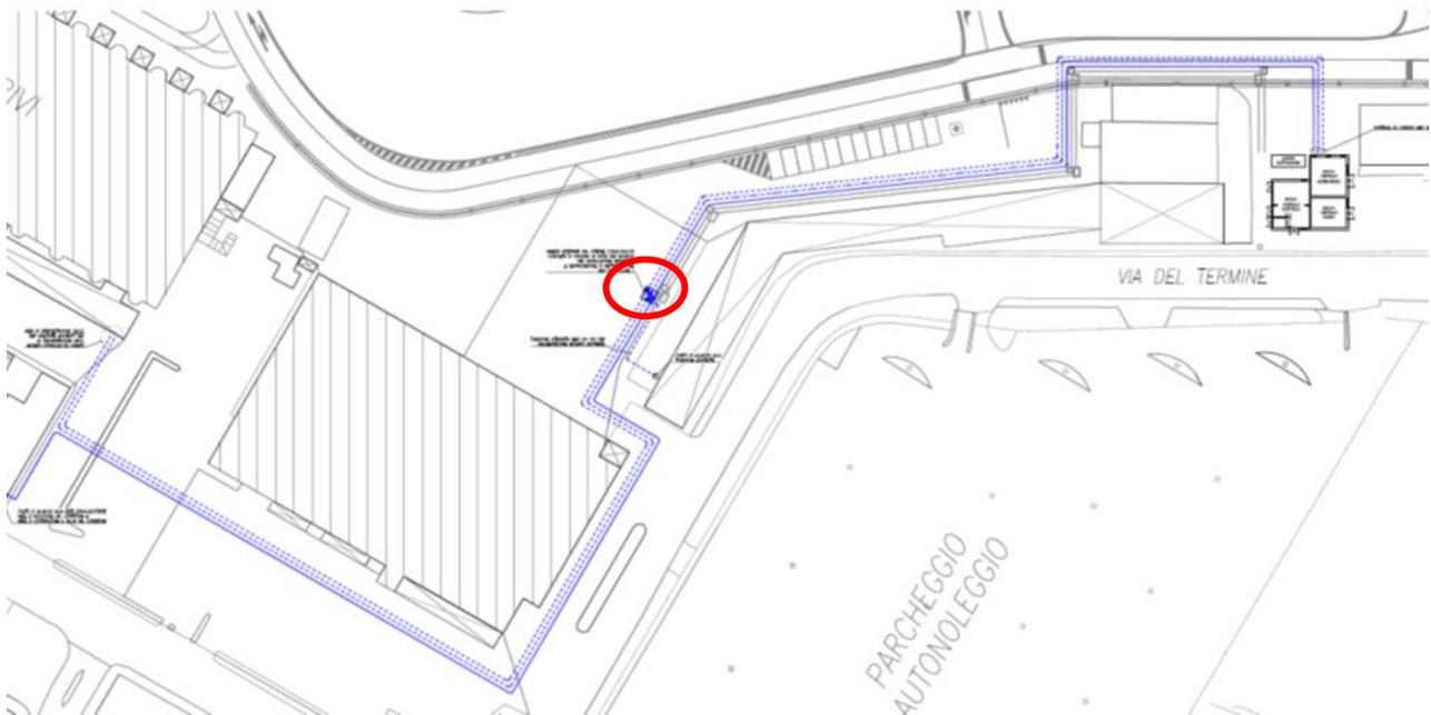
Le tubazioni continuano con un ramo ad alimentare l'autoclave di rampa e un'altra dorsale che passa lateralmente al terminal, attraversa il parcheggio sosta breve fino ad innestarsi nel blocco L e in prossimità di due grandi pozzetti nel terminal passeggeri.
