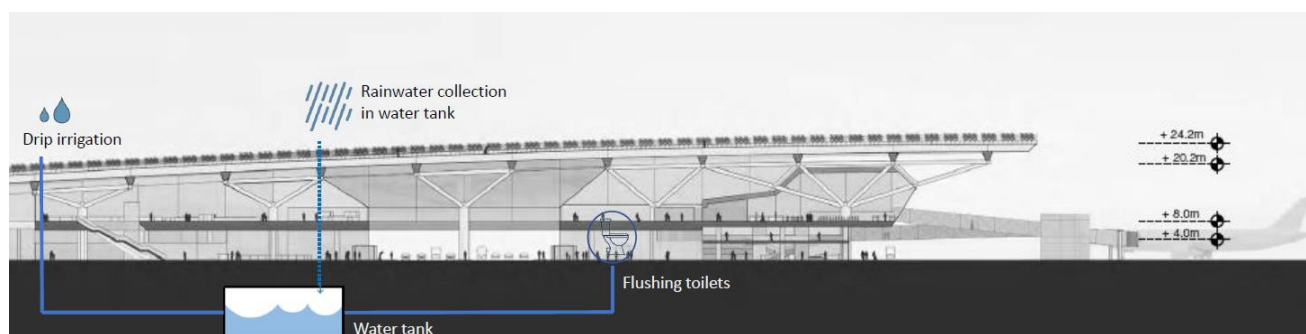
Figura 49 - Schema di recupero e riutilizzo acque meteoriche
