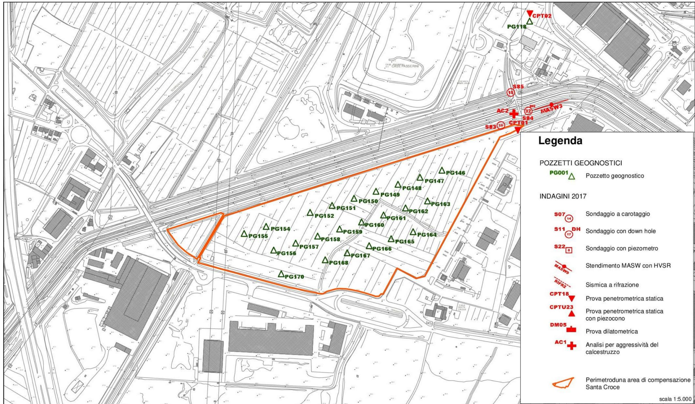
Figura 6 - Ubicazione delle indagini geognostiche realizzate in scala 1:5.000.
